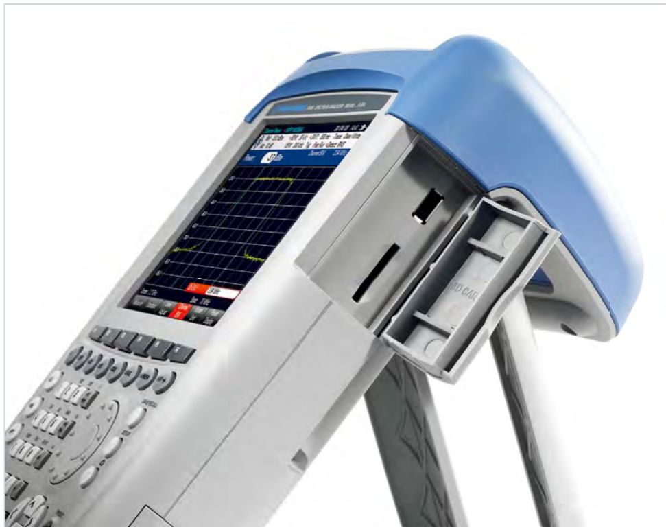
附加连接器 (例如, LAN和USB) 受铰链盖保护
