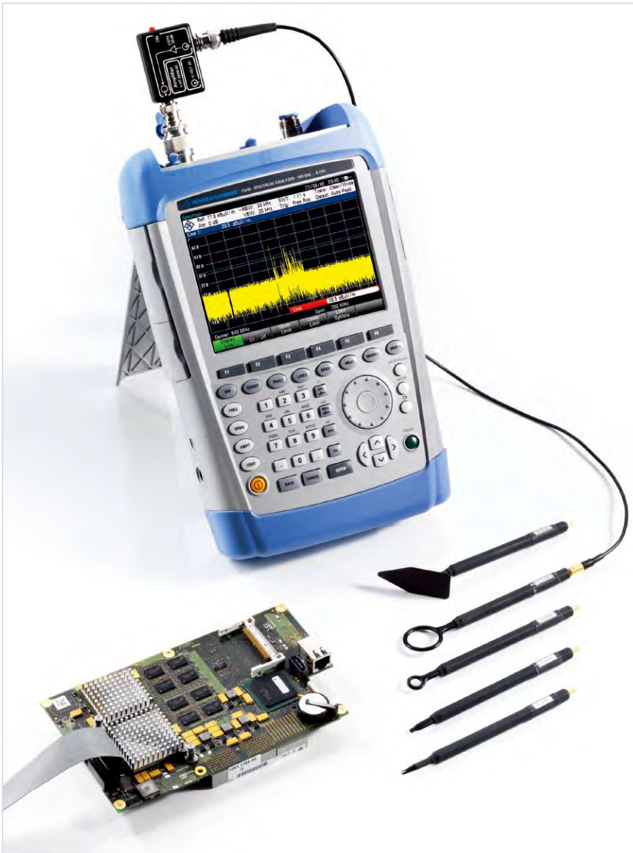
带近场探头的FSH与待测设备 (DUT)
