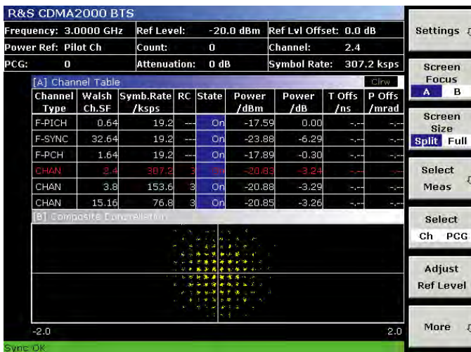
屏幕上半部分显示了所测量信道的概要情况和许多参数，例如功率和定时偏移等。下半部分显示了信号的复合星座图。
