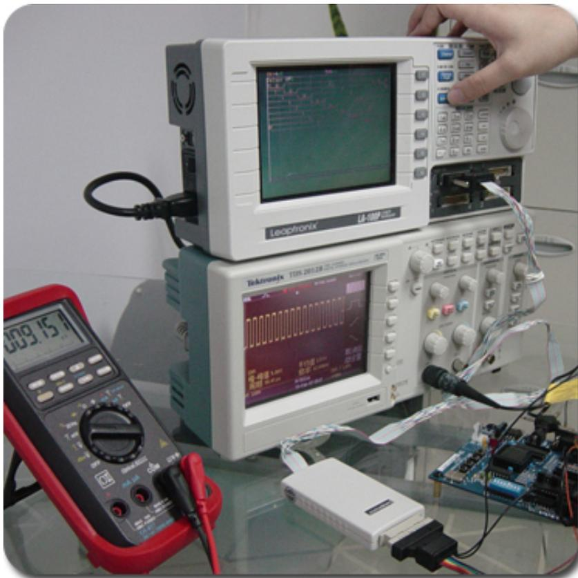
逻辑分析仪是利用时钟从测试设备上采集和显示数字信号的仪器，最主要作用在于时序判定。由于逻辑分析仪不像示波器那样有许多电压等级，通常只显示两个电压(逻辑 1 和 0)，因此设定了参考电压后，逻辑分析仪将被测信号通过比较器进行判定，高于参考电压者为 High，低于参考电压者为 Low，在 High 与 Low 之间形成数字波形。例如：一个待测信号使用 200MHz 采样率的逻辑分析仪，当参考电压设定为 1.5V 时，在测量时逻辑分析仪就会平均每 5ns 采取一个点，超过 1.5V 者为 High(逻辑 1)，低于 1.5V 者为 Low(逻辑 0)，而后的逻辑
