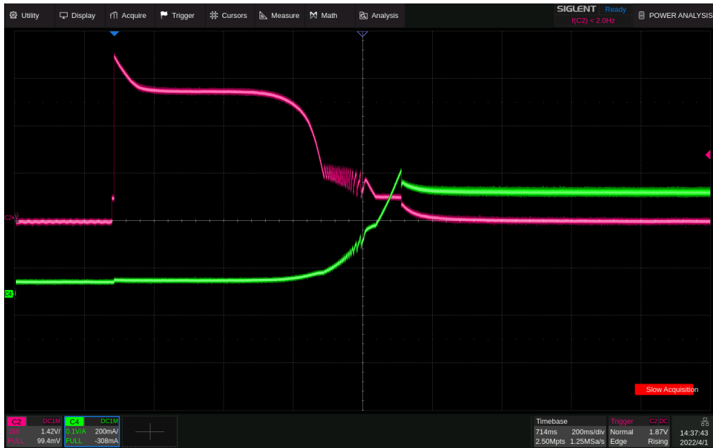
上电时 MOSFET 上的电压和电流波形
