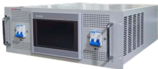
DH1750 变频电源系列是将市电中的交流电经过 AC → DC → AC 变换，输出为纯净的正弦波，输出频率和电压一定范围内可调。变频电源十分接近于理想交流电源，因此，先进发达国家越来越多地将变频电源用作标准供电电源，以便为用电器提供最优良的供电环境，便于客观考核用电器的技术性能。
