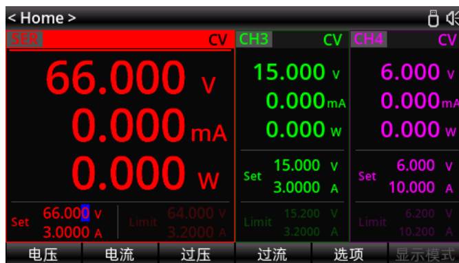
图 5-2 串联显示界面
