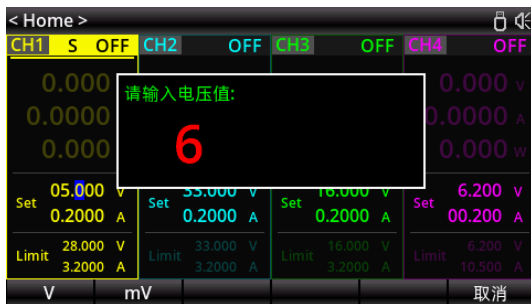
图 4-1 电压数字按键输入界面
