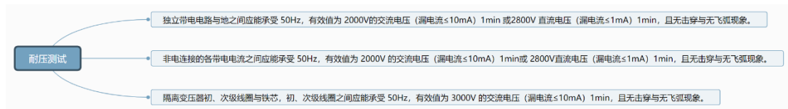
图 3 UPS 耐压测试项目
