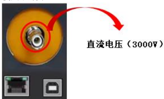
图 29 直流电压3000V测量接线图
