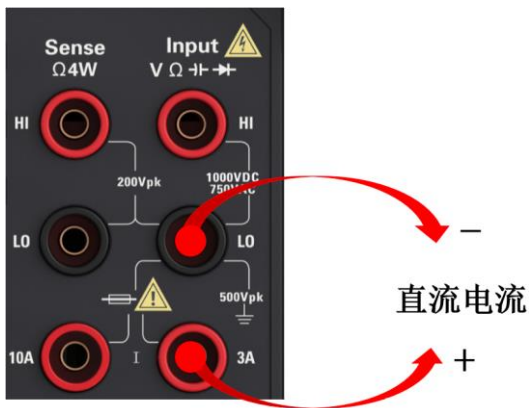
图 39 直流电流测量小电流接线图
