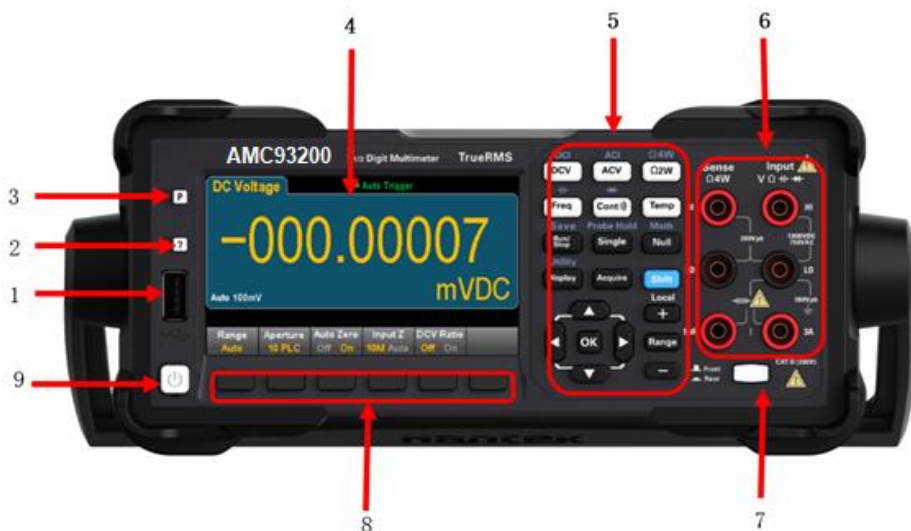
图 1 AMC93200 系列多用表前面板示意图
