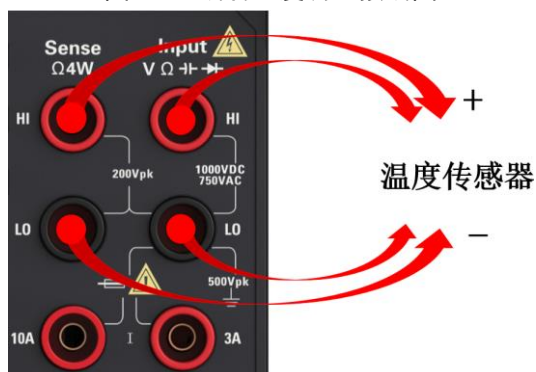
图 59 二线制温度测量接线图
