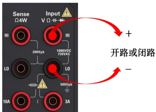
图 68 连续性测量接线图
