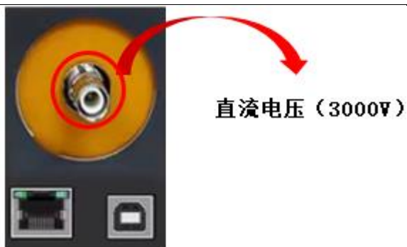
图 8 直流电压 3000V 测量接线图
