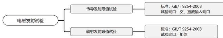
图 2 UPS 电磁发射试验项目
