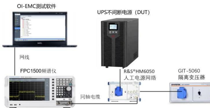
图 3 UPS 传导发射试验配置
