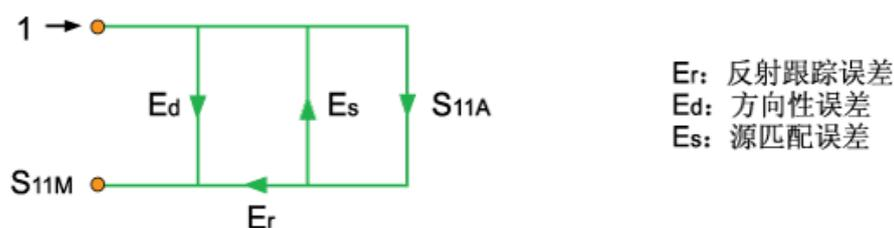
全一端口校准分别将 **Open**，**Short**，**Load** 校准件连接到测试端口上，即可计算得到测试装置误差模型中的反射跟踪误差，方向性误差以及源匹配误差。
