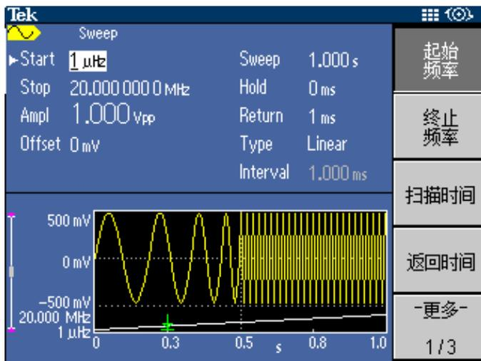
频率范围在 1 μHz 到 20 MHz 之间，支持各种放大器和滤波器测试应用。
