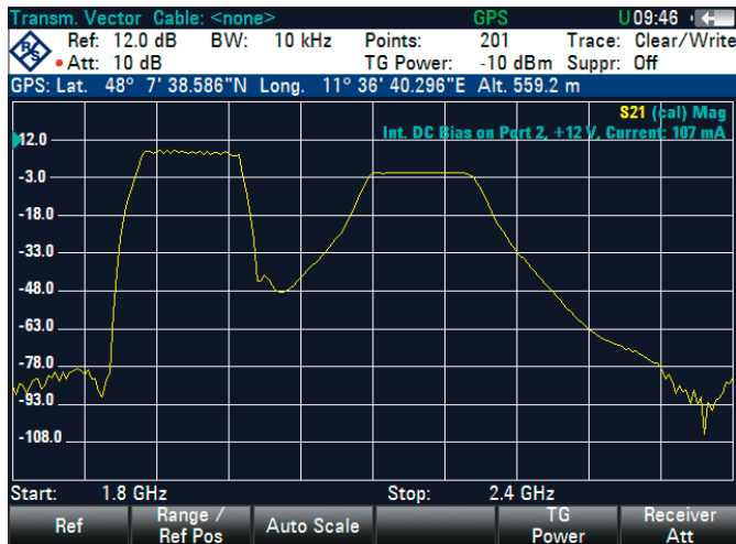
TMA传输测量：内置电压供电，电流测量，已连接R&S®HA-Z240 GPS接收机。
